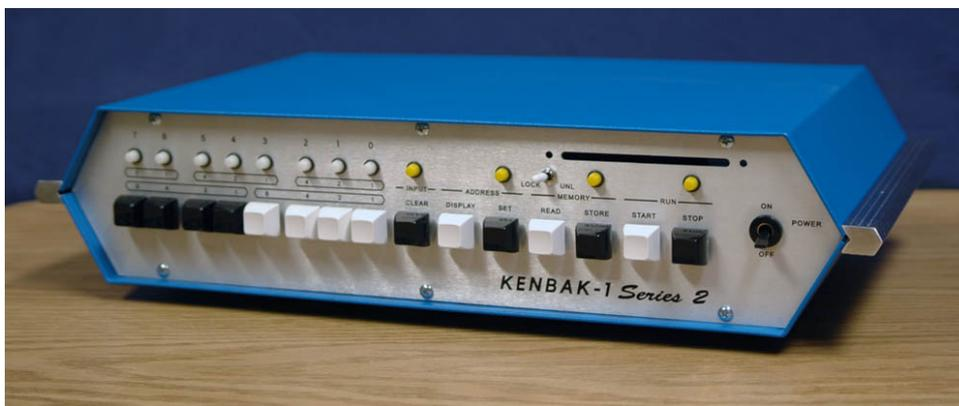
Une des particularités du Kenbak-1, réalisé par John Blankenbaker, était d'être dépourvu de microprocesseur (ou de microcontrôleur de façon plus générale). Toute la logique qui permettait à cet ordinateur de fonctionner était réalisée et câblée « à la main », ce qui le rendait lourd, encombrant, cher, plus vulnérable aux pannes, plus difficile à diagnostiquer, à réparer et à produire.
